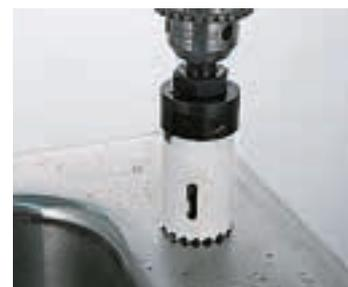
**Hinweis:** Für das Schneiden von Keramik-Wandfliesen empfehlen wir die Verwendung eines hartmetallbestückten Pilotbohrers. Der Pilotbohrer 123CT passt zu den Haltern 1L, 2L, 4L und 7L. Der Pilotbohrer 65CTPD passt zu den Haltern 5L und 6L.
