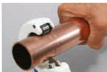
Die Multi 67 Rohrschere kann für Kunststoff- und Verbundrohre bis zu 67mm Rohrdicke sowie Kupfer- und Edelstahlrohre verwendet werden.
